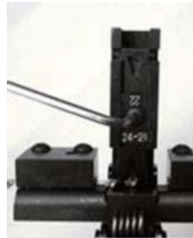
写真4 固定ネジの締め付け
