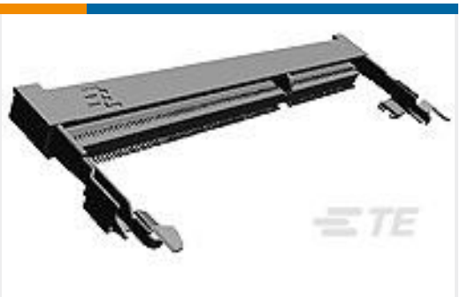
TE 产品编号2-2013289-2 EMBOSS TAPE DDR3 204P 5.2H STD Au 0.25
