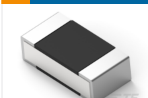
TE 产品编号1-2176308-2 RP 1E 0.1W 174K 0.1% 25PPM 5K RL
