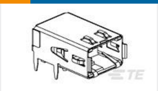
TE 产品编号1761072-3 RECPT,HSSDC2,FIBRE,TRAY PKG
