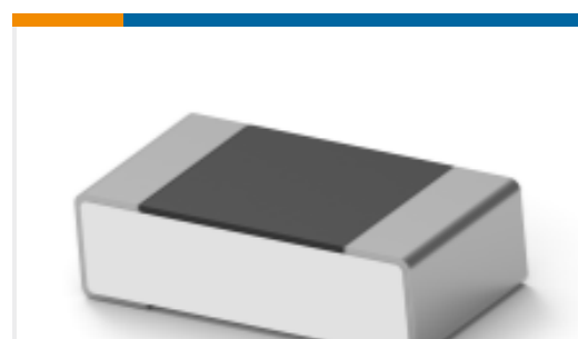
TE 产品编号 1-2176371-9 RQ 0603 7K15 0.1% 10PPM 5K RL
