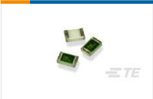
TE 产品编号1879339-3 CPF 0603 301K 1% 50PPM 1K RL
