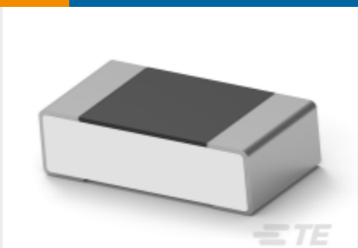
TE 产品编号7-2176371-3 RQ 0603 26K1 0.1% 10PPM 5K RL
