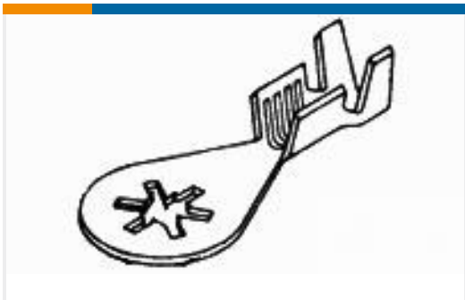
TE 产品编号62613-2 RING .190 12-10 AWG 0245 TPCRS
