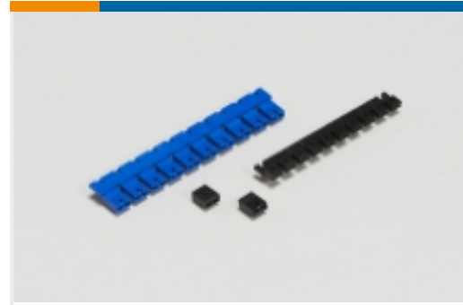
板对板跳线和分路(5)
