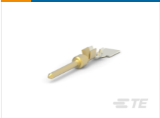
TE 产品编号166054-1 D-Sub 连接器端子：针脚，黄铜，信号，20 号
