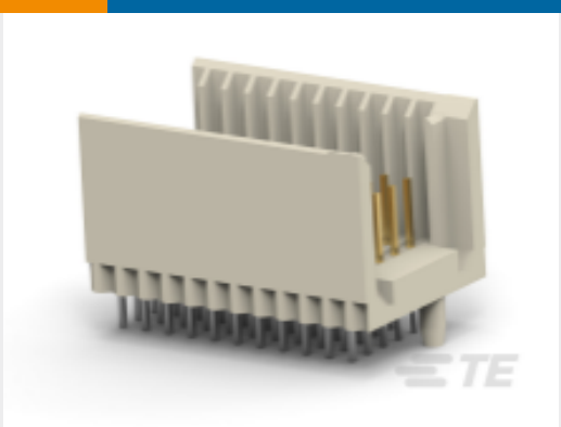
TE 产品编号646347-1 硬公制公连接器：传统背板，夹层，2mm
