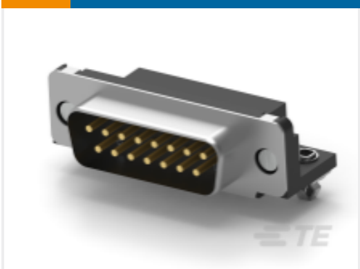
TE 产品编号1-338169-2 D-Sub 插头组件：标准，直角，外壳尺寸 2，2.74mm
