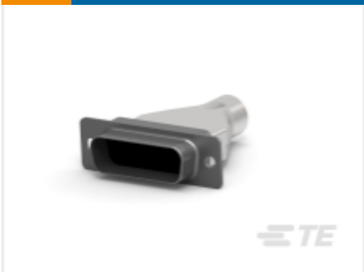
TE 产品编号205206-9 D-Sub 压接：插头，信号，15 针脚，20 号插针，外壳尺寸 2
