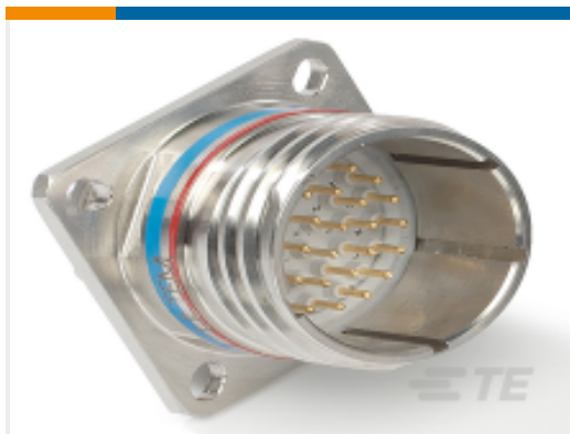
TE 产品编号 CAT-D38999-DTS5B D38999：方形凸缘，17-35 插件
