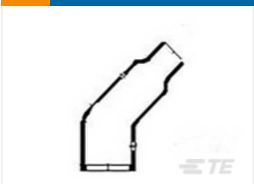
TE 产品编号642427-000 热缩护套：聚合物成型，有嘴
