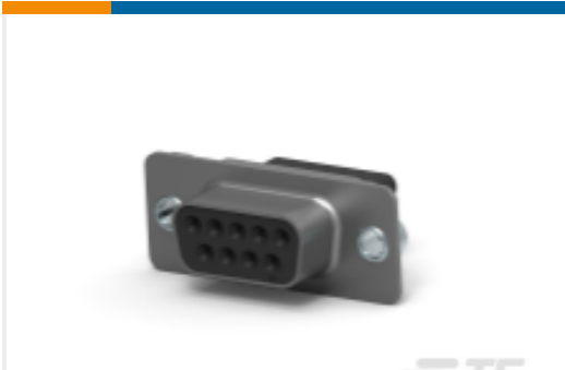
TE 产品编号164531-4 D-Sub 压接插座，信号，9 针脚，20 号插座，外壳尺寸 1
