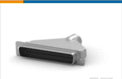
TE 产品编号205210-8 D-Sub 压接：插头，信号，37 针脚，20 号插针，外壳尺寸 4
