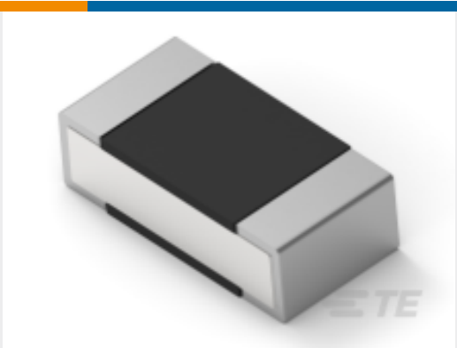
TE 产品编号8-2176312-9 RP 1E 0.1W 102K 0.1% 25PPM 1K RL
