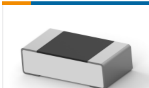
TE 产品编号1-2176372-3 RQ 0603 66K5 0.1% 10PPM 5K RL
