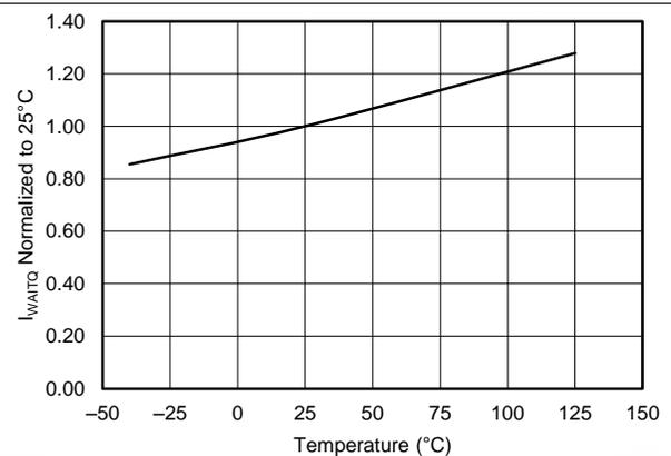
Figure 19.  $I_{WAITQ}$  vs Temperature
