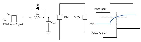
Figure 26. Using RCD Circuits
