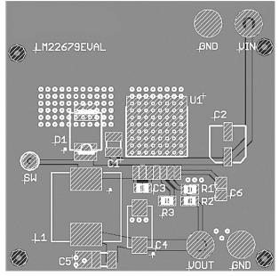
图 10-2. LM22679 Layout Example
