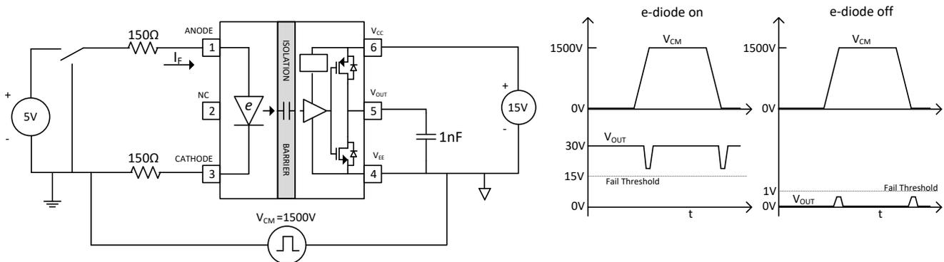
图 18. CMTI Test Circuit for UCC23511
