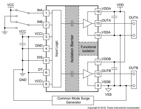
图 33. Simplified CMTI Testing Setup
