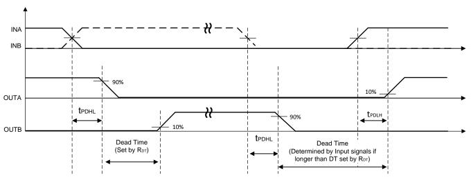
图 30. Dead Time Switching Parameters
